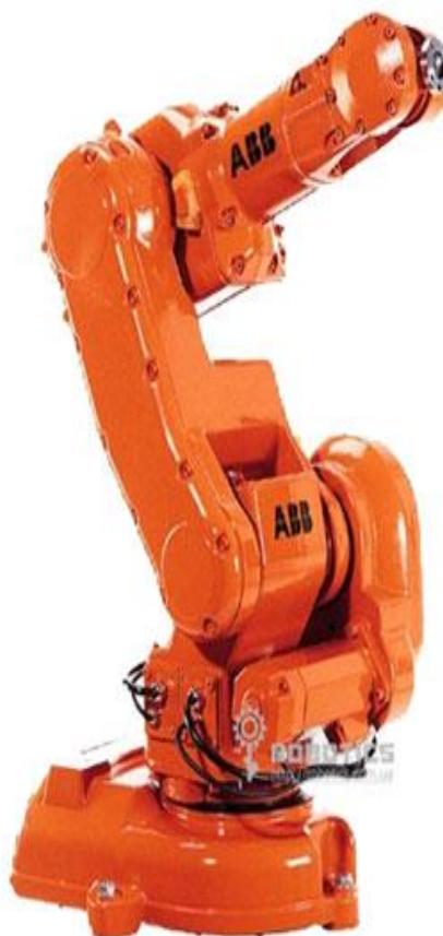
1.1 - сурет – АBB өндірісінің өнеркәсіптік манипуляторы.
